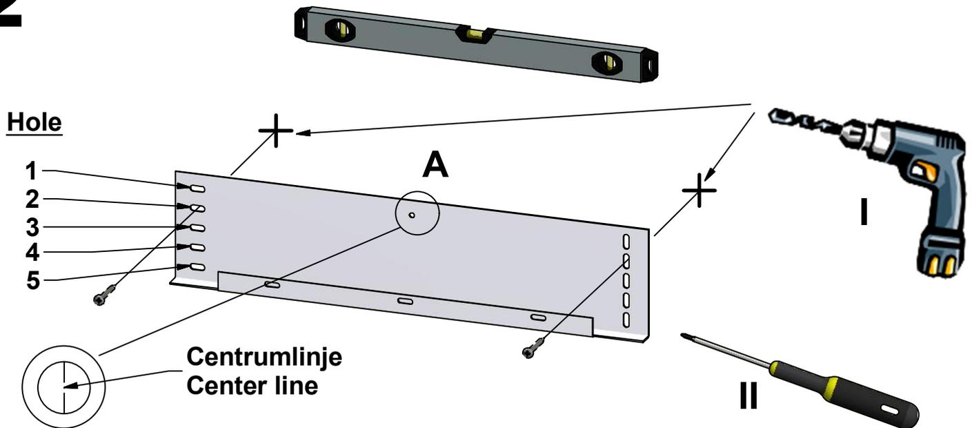
Skruvinfästningar i våtzon 1 ska göras i betong eller annan massiv konstruktion, träreglar, träkortlingar eller i konstruktion som är provad och godkänd för infästning, till exempel skivkonstruktion. Se exempel på godkända konstruktioner på säkervatten.se.
