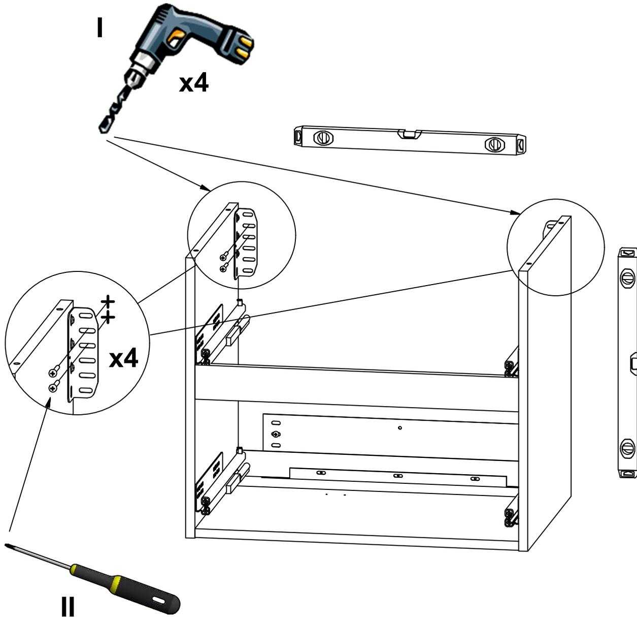
Skruvfästningar i våtzon 1 ska göras i betong eller annan massiv konstruktion, träreglar, träkörtlingar eller i konstruktion som är provad och godkänd för infästning, till exempel skivkonstruktion. Se exempel på godkända konstruktioner på säkervatten.se.
